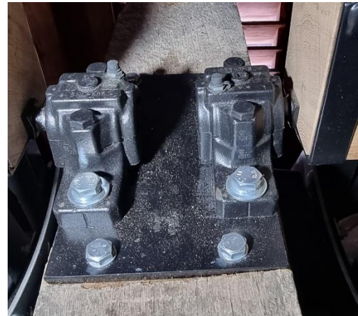
Lagerführung neu mit Pendelkugellager und geschmierten Lagergehäusen
