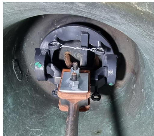
Klöppelaufhängung neu Kugelgelagert und seitlich geführt. Rindsleder doppellagig.
